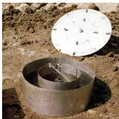
Meting met de tweering-infiltratiemethode. foto: Beeldbank Rijkswaterstaat/Wim Polderman
