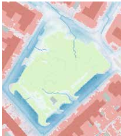
▲ Stroombanenkaart en wateroverlastkaart (2D-stromingsmodel, bui van 100mm in 2 uur). Opmerkelijk resultaat: De stroombanen laten zien dat de wateroverlast bij hevige neerslag deels komt door afstroming vanaf het onverharde speelveldje.
