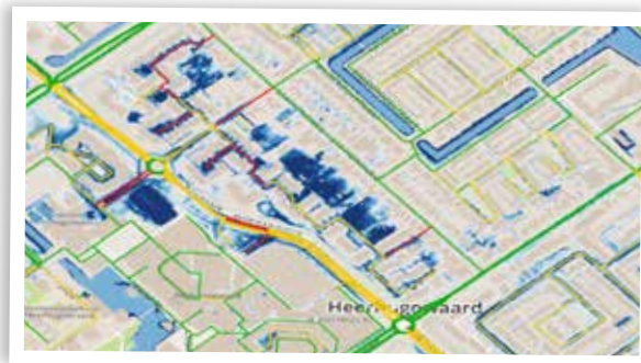
▲ Figuur1 Kaart met begaanbaarheid wegen, als doorvertaling van de wateroverlastkaart (bui van 60 mm in een uur).
